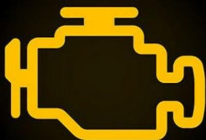
Testigo check engine, indica falla o fallas en sistemas relacionados con el motor, es recomendable llevar el vehículo a un taller para determinar la falla; este testigo enciende porque los siguientes sistemas están en mal estado: inyección, emisiones de gases, electrónico, encendido.
