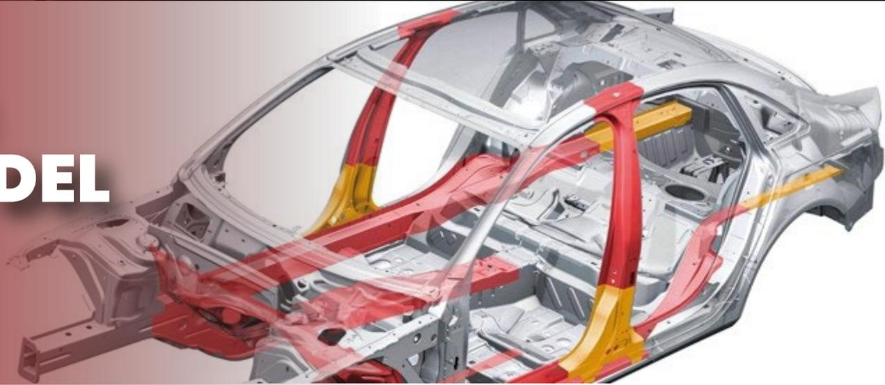
Las "zonas de deformación" en un vehículo se refieren a áreas específicas diseñadas para absorber energía en caso de un impacto. Estas áreas están estratégicamente ubicadas para proteger a los ocupantes del vehículo al disipar la energía del choque y reducir la transferencia de fuerzas a la cabina del vehículo.
