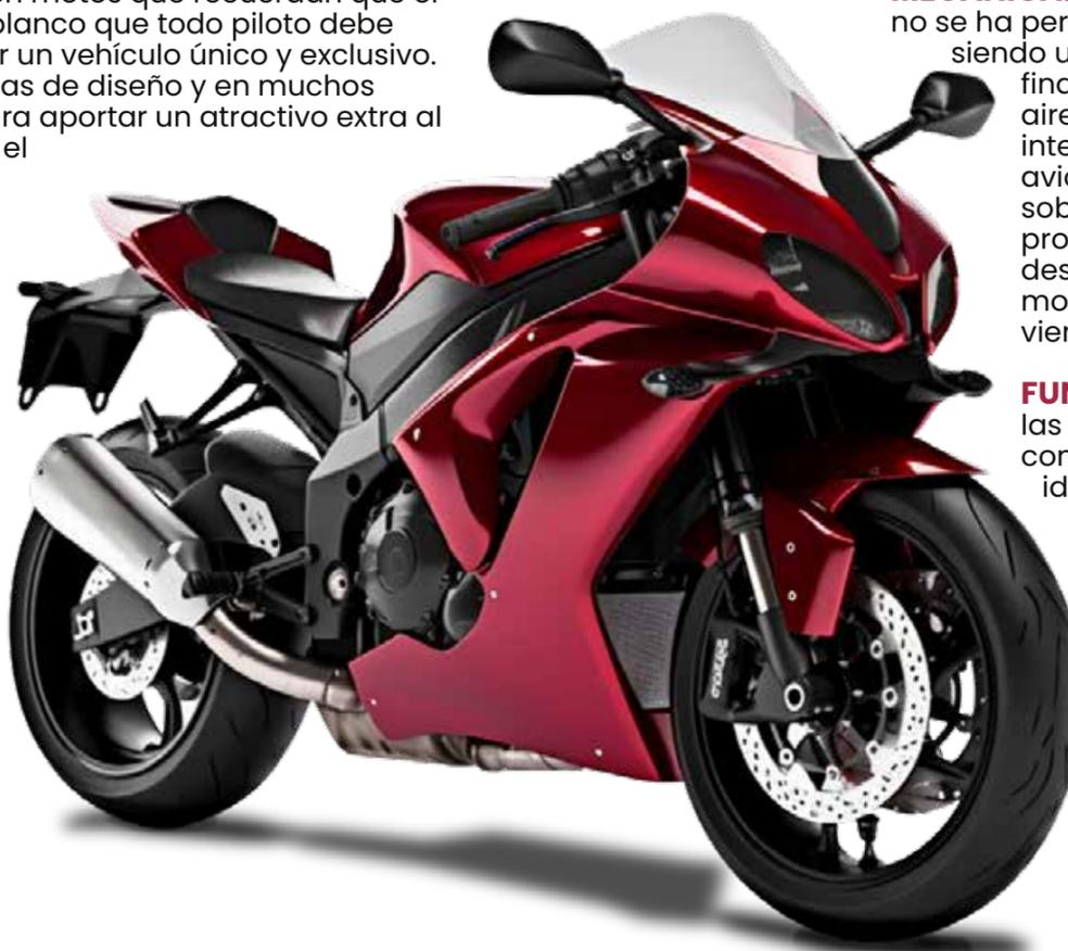
**MECÁNICA:** La misión originaria del carenado no se ha perdido en las motos actuales. Sigue siendo una pieza clave que tiene la finalidad de facilitar la entrada de aire a alta velocidad. ¿Sabes cómo interviene la línea de las alas en un avión? Pues la función del carenado sobre dos ruedas es semejante: provoca que el viento corra y se deslice sobre la superficie de la moto, evitando que la fuerza del viento frene tu moto.
