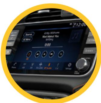
Estos sistemas vienen preinstalados en el automóvil por el fabricante y están diseñados específicamente para ese modelo. Suelen tener una pantalla táctil en el tablero que controla las funciones de navegación, música, teléfono y otras características del vehículo.
