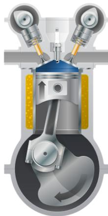
En el ciclo de compresión, el pistón se mueve hacia arriba nuevamente, comprimiendo la mezcla de aire y combustible en el cilindro. Esta compresión aumenta la presión y la temperatura de la mezcla, preparándola para la ignición.
