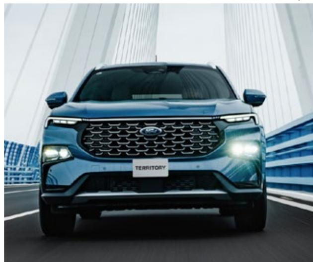
Ford Territory llega a México en tres versiones: Ambiente, Trend y Titanium y está equipada con un motor de 1.8 litros turbo EcoBoost®, el cual brinda una potencia de 187 caballos de fuerza y 236 lb-pie de torque. Todas las versiones incluyen una transmisión automática de 7 velocidades, así como Freno de Mano Eléctrico con Auto-Hold, Frenos de Disco en las 4 Ruedas con ABS y Tracción Delantera (FWD). El precio aún está por definirse.
