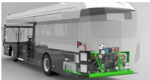
La empresa experta en repotenciación de autobuses Kleanbus revela hoy las primeras imágenes de su avanzada tecnología de plataforma modular, que puede convertir cualquier autobús, ya sea de uno o dos pisos, de ICE a totalmente eléctrico de forma rápida y rentable. Con el aumento del cambio climático y la mala calidad del aire en las ciudades alcanzando niveles críticos, la descarbonización del transporte se ha convertido en uno de los mayores desafíos de nuestro tiempo.
