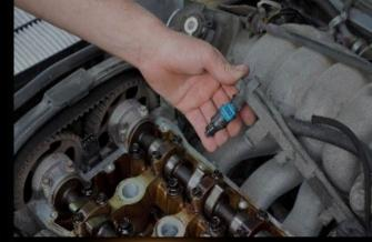
Debido a que los inyectores están en continuo contacto con el combustible, es necesario realizar una limpieza adecuada de los mismos de manera periódica; lo recomendable es realizar dicho servicio cada 50,000 o 60,000 kilómetros y, cuando se realice el servicio, cambiar los sellos (o-rings) de inyectores, ya que estos con el paso del tiempo se irán resecando y agrietando.
