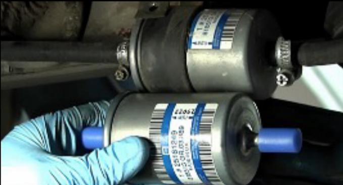
Es necesario cambiar el filtro del combustible periódicamente para que el carburante (combustible) llegue siempre limpio al sistema de inyección. Procura que el combustible sea de buena calidad, ya que de lo contrario el filtro puede no funcionar de manera óptima y se pueden generar fallas en el vehículo.
